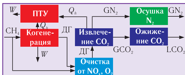
Рис. 5. Схема энерготехнологического комплекса, использующего когенерационную и паротурбинную установки, со сгоранием природного газа в генераторе CO_2 для получения: электроэнергии ( W ), теплоты ( Q_h ), жидкого диоксида углерода ( LCO_2 ) и чистого газообразного азота ( GN_2 )
