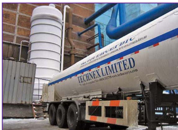
Фото 9. Полуприцеп украинской сборки заправляется жидким аргонем для проведения ходовых испытаний, отработки технологий заправки криопродуктами и их слива в стационарные криогенные резервуары
